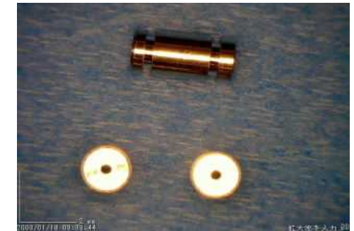
アルミ部品 貫通穴 0.5 材質 A2011
